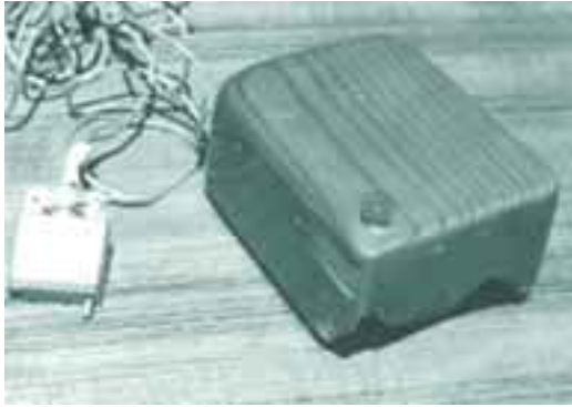
Ensimmäinen hiiri oli tehty puusta, sen pohjassa oli kaksi pyörää ja päällä yksi punainen nappi-painike. Nimen hiiri se sai vähän myöhemmin ihan vain siksi, että se "hännällisenä" muistutti hiirtä.
