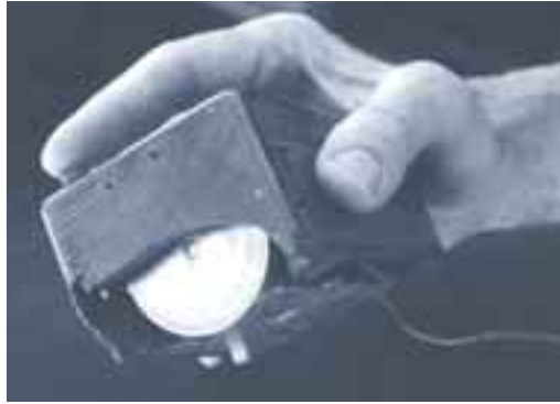
Ensimmäinen hiiri oli tehty puusta, sen pohjassa oli kaksi pyörää ja päällä yksi punainen nappi-painike. Nimen hiiri se sai vähän myöhemmin ihan vain siksi, että se "hännällisenä" muistutti hiirtä.
